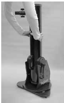
Abbildung 5. Setzen Sie das Optiktrohr so in die „Lagerschale“ an der Basis ein, dass die seitlichen Höhenlager am Optiktrohr auf den weißen Kunststoffpads aufliegen. Wenn das CorrecTension-System noch nicht montiert und eingerichtet ist, stellen Sie das Teleskop wie in der Abbildung gezeigt hin, damit es nicht kippt.
