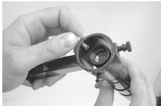
Abbildung 8b: Montieren des Sucherfernrohrs an der dafür vorgesehenen Halterung.
