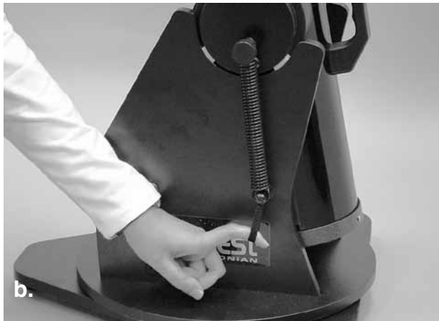
Abbildung 7: (a) Um die Feder an der Basis zu befestigen, ziehen Sie sie an der Zugschleife nach unten. (b) Ziehen Sie den Endring der Feder über den Schraubenkopf auf den schmalen Teil des Nylon-Distanzstücks. Lassen Sie die Zugschleife dann los.
