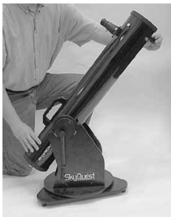
Abbildung 11: Halten Sie das Teleskop beim Ausrichten wie in der Abbildung gezeigt. Richten Sie das Teleskop mit der linken Hand am Navigationsknauf aus, während Sie es mit der rechten Hand an der Rückseite des Optiktrohrs stützen.
