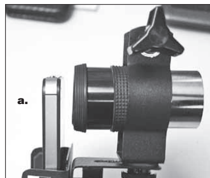
Figura 5. La lente del ocular debe estar plana en relación con el smartphone ( a ), no inclinada en un ángulo ( b ).
