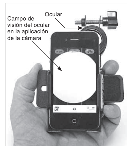
Figura 6. Coloque el ocular del telescopio de manera que su campo de visión aparezca más o menos centrado en la pantalla del teléfono.
