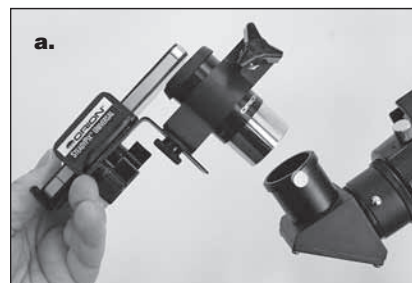
Figura 7. Inserción del ocular con el adaptador y el teléfono conectado en la diagonal estelar. Antes de hacer esto, asegúrese de que la diagonal está firmemente asegurada en el enfocador del telescopio.
