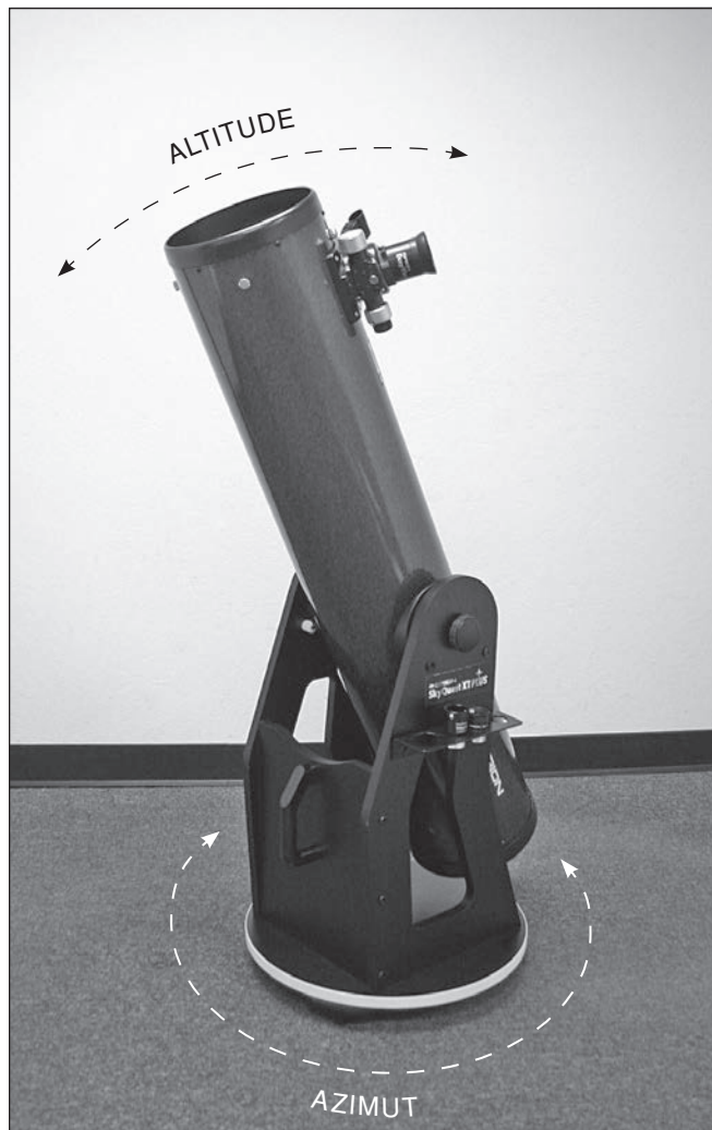
Figure 13. Les télescopes XT PLUS Dobson sont des télescopes « manuels » qui ont deux sens de déplacement : altitude (haut / bas) et azimut (gauche / droite). Saisissez simplement l'avant du télescope et déplacez-le vers l'endroit voulu dans le ciel.
