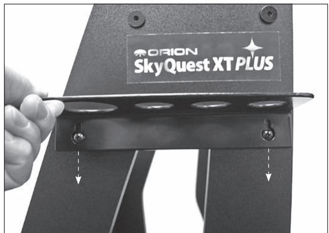
Figure 7. Placez les trous de serrure de la tablette porte-oculaire sur les vis de montage, puis appuyez sur la tablette vers le bas et serrez les vis. (Tablette XT8 PLUS représentée)
