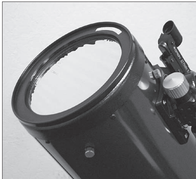
Figure 20. Le filtre solaire à film de sécurité inclus s'enclenche à l'avant du télescope pour visualiser en toute sécurité notre soleil à travers l'oculaire du télescope. Ne regardez PAS à travers l'EZ Finder II pour centrer le soleil dans le champ de vision du télescope !
