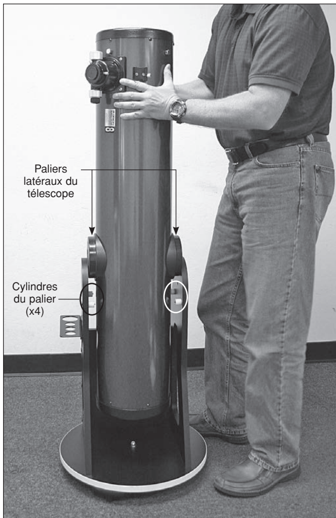
Figure 8. Placez délicatement le télescope dans la base en posant les paliers latéraux du télescope sur les cylindres du palier.
