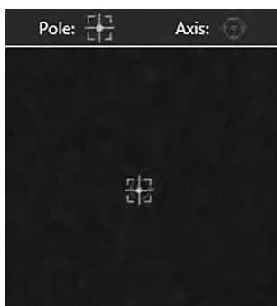
Figure 10. Les deux réticules alignés. L'alignement polaire précis a été réalisé.
