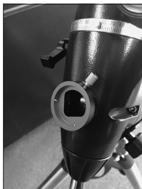
Figure 2. La section de la bague de la monture insérée dans l'ouverture de l'axe polaire de la monture.
